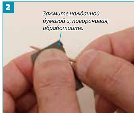
2 Обработайте стержень со всех сторон наждачной бумагой.
