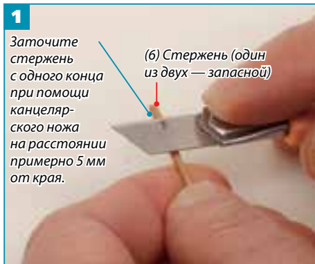
1 Деталь (6) заострите с одного края на расстоянии около 5 мм при помощи канцелярского ножа.
