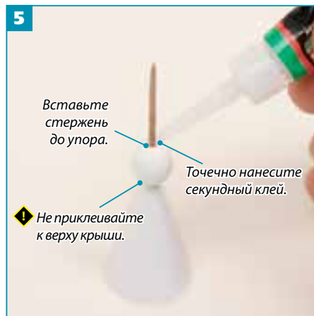
5 Вставьте стержень в деталь (4) верх крыши до упора, а затем точно нанесите секундный клей вверх, на место соединения стержня и детали (5).
